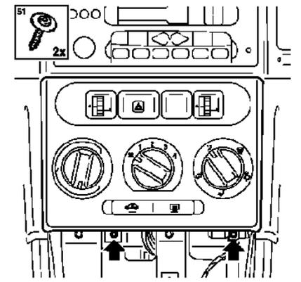
Warnblinker (4), TC-Schalter (3) und Schalter Sitzheizung (2) nach vorne ziehen und Kabelsatzstecker (1) abziehen.
